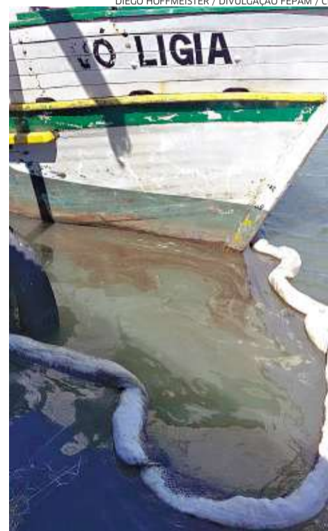
Barreira impede que a mancha se espalhe
