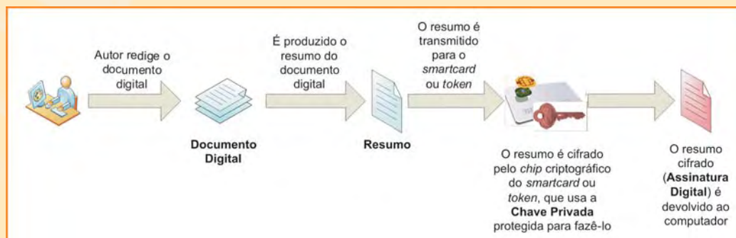
Figura 8 – Assinatura Digital com Certificados Digitais A3
