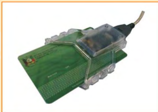
Figura 10 – Smartcard do TJRS inserido na leitora
